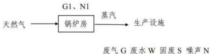
图 1 工艺及排污节点图
